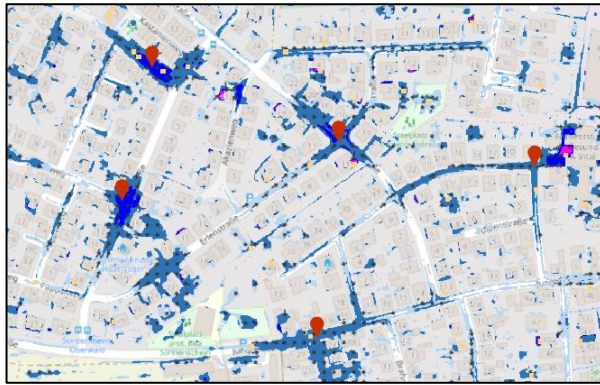
Abbildung 10: nördlicher Siedlungsbereich von Sondernheim - Auszug Sturzflutgefahrenkarte SRI7, 1Std; Fließrichtung und Wassertiefe (Markiert sind Stellen mit höheren Wassertiefen)
