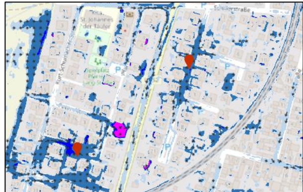
Abbildung 11: südlicher Siedlungsbereich von Sondernheim - Auszug Sturzflutgefahrenkarte SRI7, 1Std; Fließrichtung und Wassertiefe (Markiert sind Stellen mit höheren Wassertiefen)
